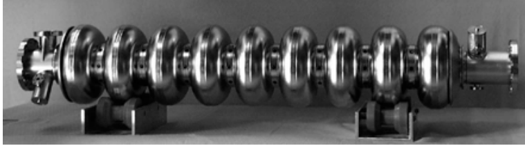
TESLA / ILC / European XFEL 1.3 GHz cavity
