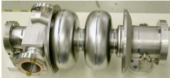
Cornell ERL injector cavity
